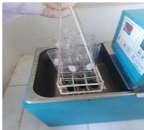
Figura 84. Introducción de batería a baño maría
