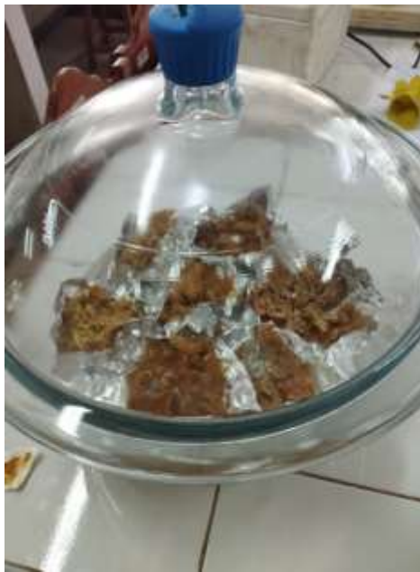
Muestra deshidratada para extracción de aceites y grasas por el método soxhlet.
