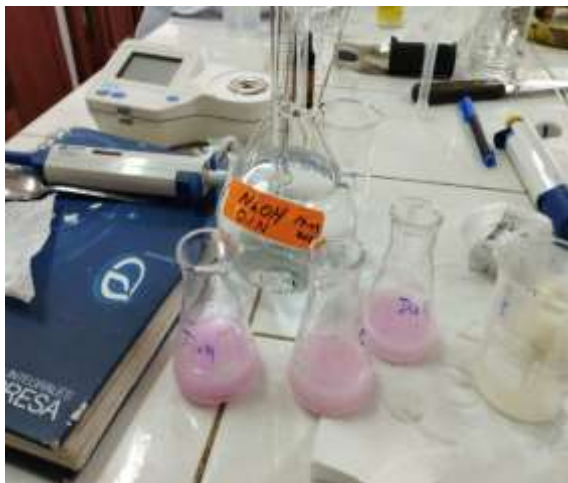
Determinación de acidez titulable y sólidos totales disueltos (°Brix).
