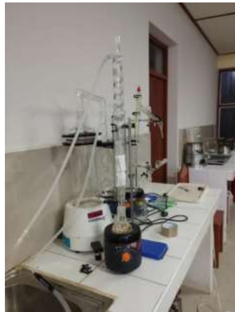
Muestra deshidratada para extracción de aceites y grasas por el método soxhlet.
