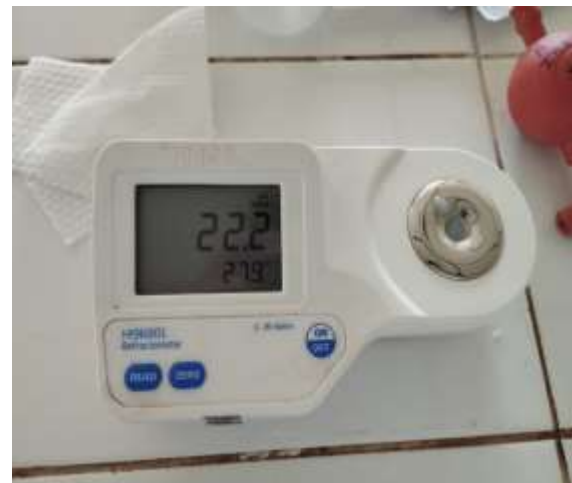
Determinación de acidez titulable y sólidos totales disueltos (°Brix).
