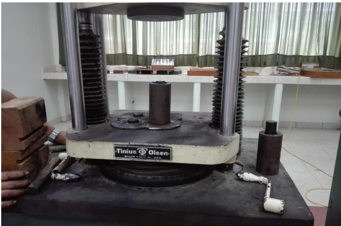
Figura 9. Prensa universal TINIUS OLSEN para el prensado de las briquetas
