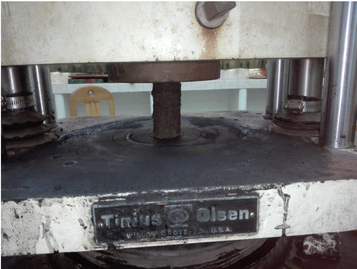
Figura 11. Prueba de compresión perpendicular las briquetas
