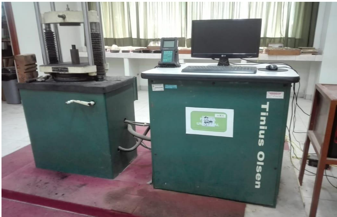
Figura 9. Prensa universal TINIUS OLSEN para el prensado de las briquetas
