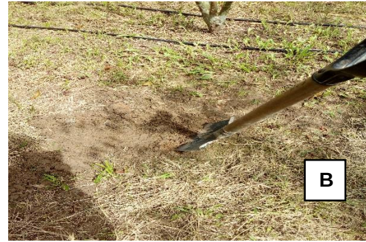
Figura 22. Obtención de la muestra de suelo: A) selección y limpieza del área a obtener, B) muestra de suelo (1 kg)
