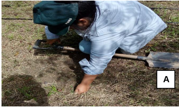
Figura 22. Obtención de la muestra de suelo: A) selección y limpieza del área a obtener, B) muestra de suelo (1 kg)
