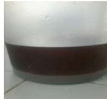
PRECIPITACIÓN DE PROTEÍNA EN EL PUNTO ISOELÉCTRICO
