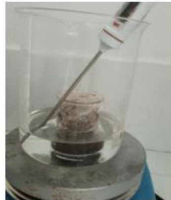
SOLUBILIZACIÓN MEDIANTE AGITACIÓN MAGNÉTICA
