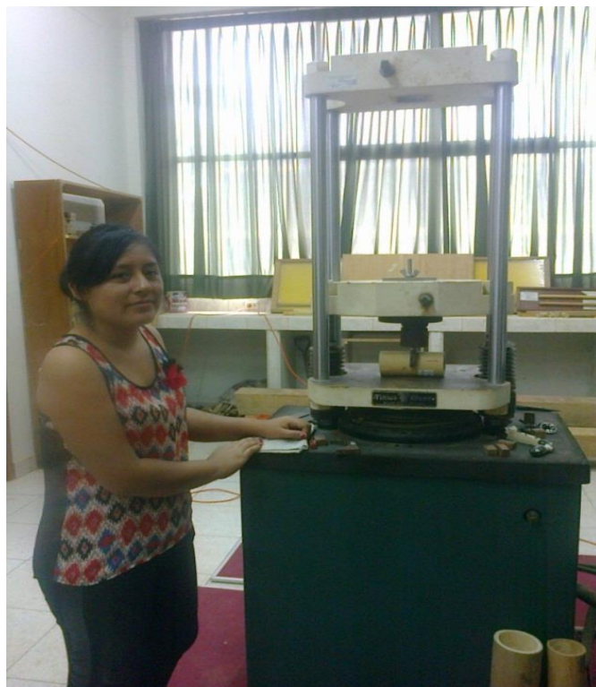
A. Montaje de prueba compresión perpendicular
