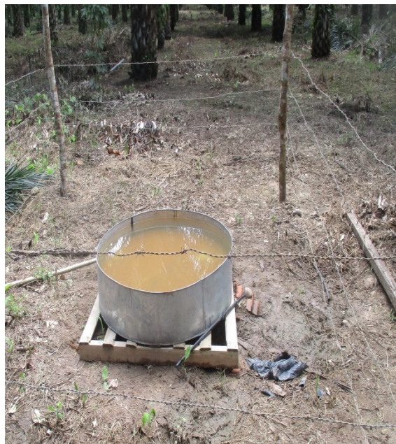
Figura 8. Instalación del Tanque de clase A. Fuente: Elaboración propia propia, 2017.
