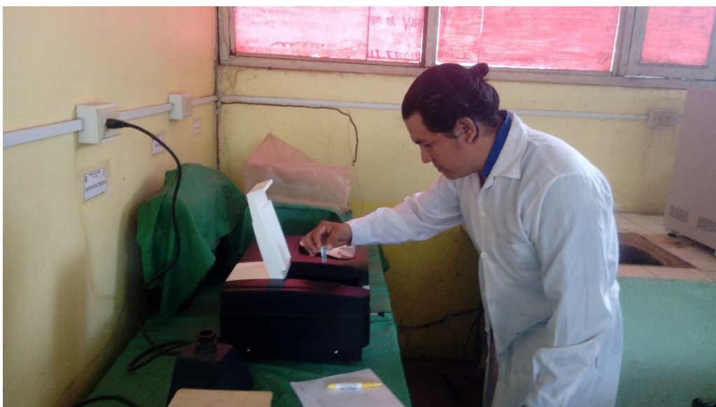
Colocación de las cubetas en el espectrofotómetro
