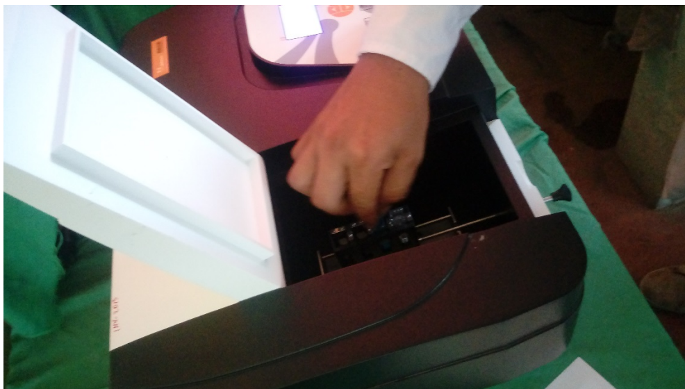
Colocación de las cubetas en el espectrofotómetro
