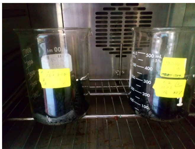
Figura 11. Secado del carbón activado de raquis de palma aceitera (Elaboración propia).
