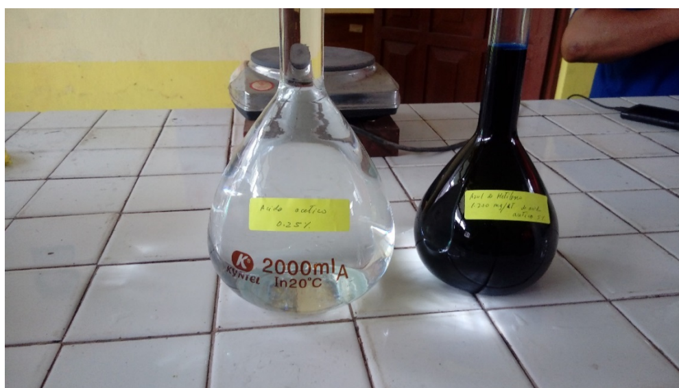
Reactivos para la prueba de adsorción del carbón activado de raquis de palma aceitera
