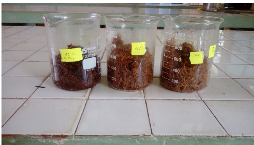
Figura 9. Muestra de raquis de palma aceitera en proceso de impregnación (Elaboración propia).
