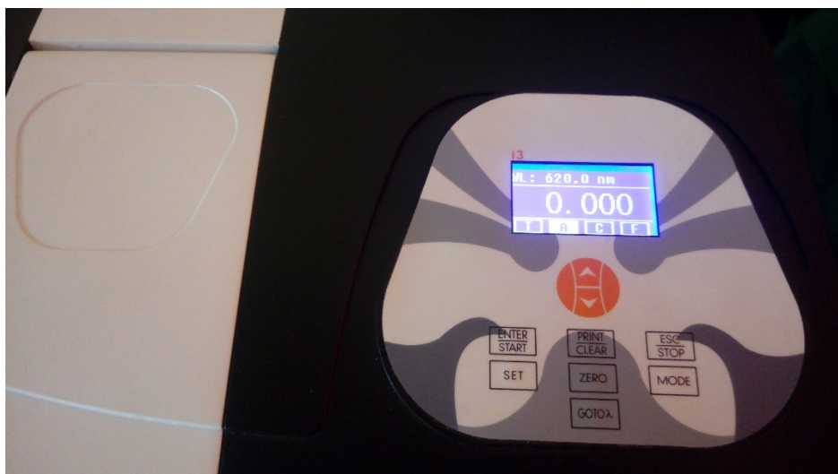
Equipo calibrado para la realización de las medidas de absorbancia.
