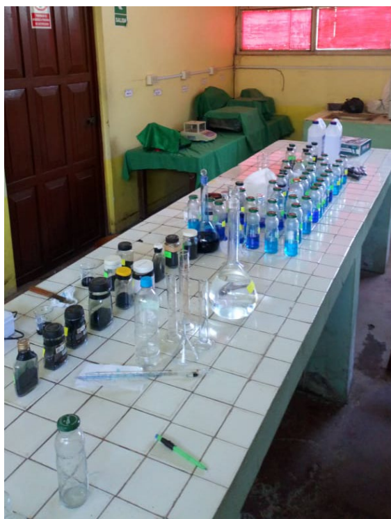
Muestras de carbón activado de palma aceitera realizando prueba con azul de metileno
