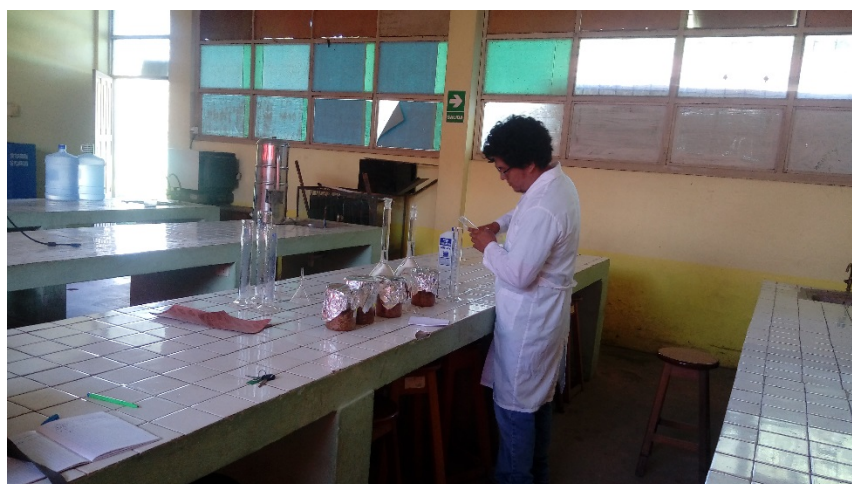
Impregnación de la muestra de raquis de palma aceitera con el ácido fosfórico
