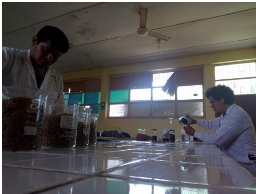
Impregnación de la muestra de raquis de palma aceitera con el ácido fosfórico
