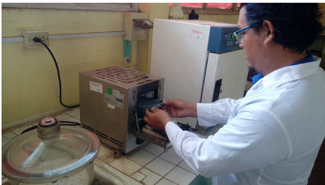
Colocación de los envases de carbonización en la mufla.
