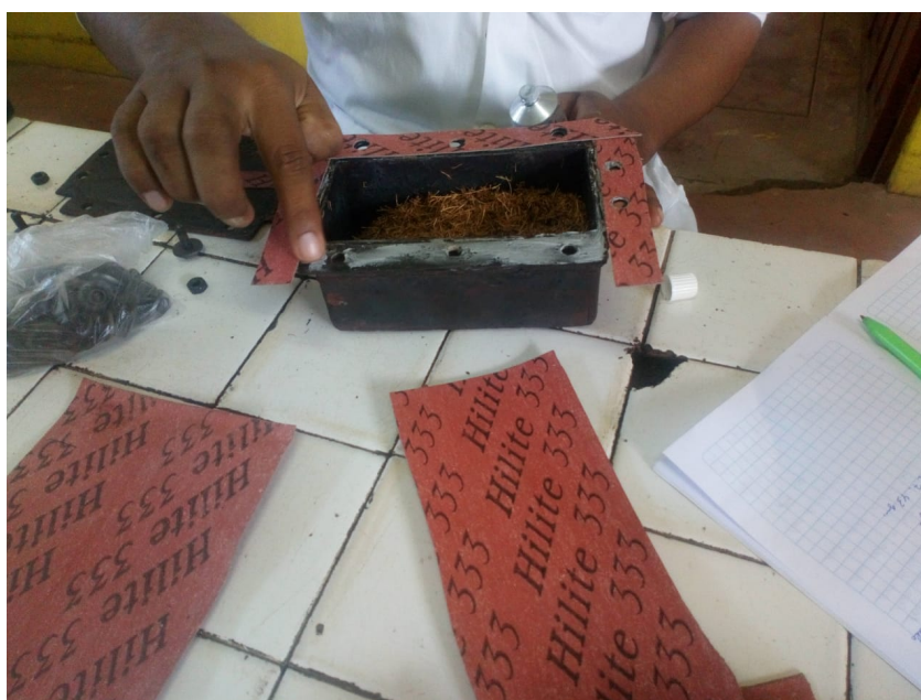
Colocación de la muestra y sellado de los envases de carbonización
