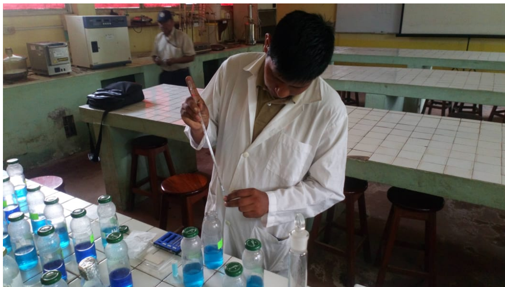
Preparando las celdas de espectrofotómetro para la medida de absorbancia.
