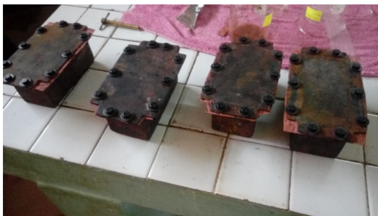
Figura 10. Envases de carbonización con las muestras listas para el ingreso a la mufla (Elaboración propia).
