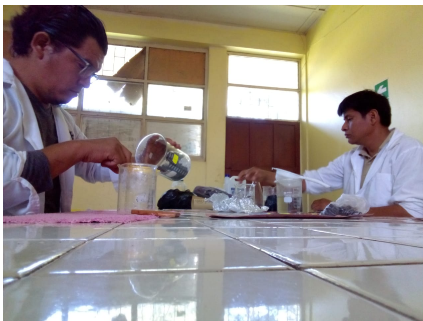
Lavado de carbón activado de raquis de palma aceitera
