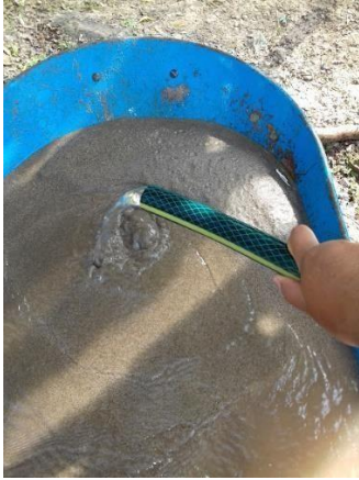
Lavado con agua de sustrato arena
